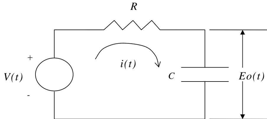
**Objetivo:** Determinar la respuesta dinámica de la tensión en el condensador  $E_o(t)$  ante una variación de  $V(t)$ .
